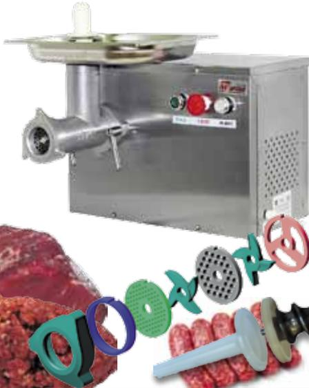
Мясорубка оснащена функцией «Реверс», которая позволяет при наматывании жил освободить шнек без дополнительной разборки. Корпус и лоток мясорубки изготавливаются из нержавеющей стали. Навесной механизм – из алюминия.
